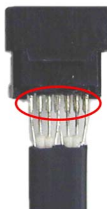
フラットケーブルはんだ付け
